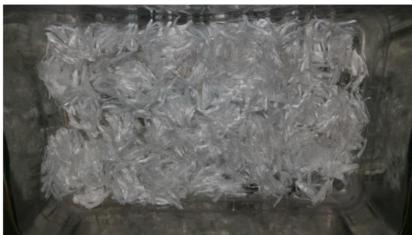
شکل ۲. الیاف مصنوعی پلی‌پروپیلن مورد استفاده در پژوهش
