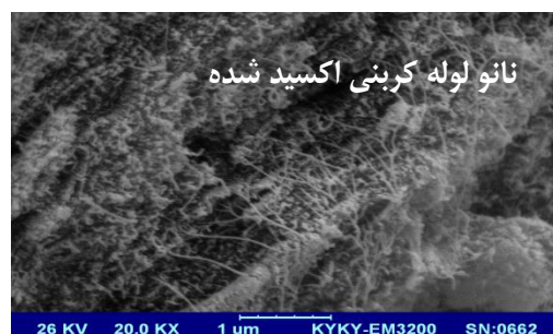
شکل ۶. مقایسه سطح سیلیس پوشش یافته و بدون پوشش و نانولوله خام و اکسیدشده با عکس‌های میکروسکوپ الکترونی روبشی
