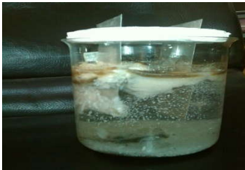
شکل شماره (۲): کیفیت پساب و لجن پس از ۱۶ ساعت الکترولیز
