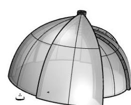
شکل ۱. الف. قوس های پایه، ب. پوسته ای ابتدایی، پ. ضخامت دهنده به پوسته، ت. تکثیر و مقیاس دهنی در حالت جمع شده به همراه تولید فرم پین بزرگ و ث. خروجی دوران یافته از الگوریتم نوشته شده در Grasshopper
