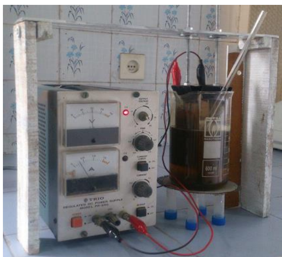
شکل ۱. سمت راست (الف) پایلوت راکتور با فلدار بی‌هوازی، سمت چپ (ب) سامانه الکتروشیمیایی پایلوت آزمایشگاهی ناپیوسته
