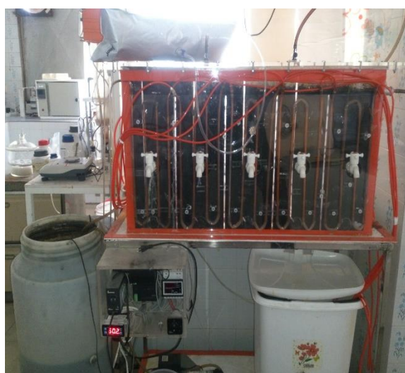
شکل ۱. سمت راست (الف) پایلوت راکتور با فلدار بی‌هوازی، سمت چپ (ب) سامانه الکتروشیمیایی پایلوت آزمایشگاهی ناپیوسته
