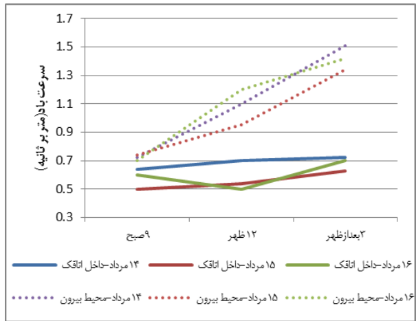
شکل ۶. سرعت هوای ورودی بادگیر به اتاقک و محیط بیرون
