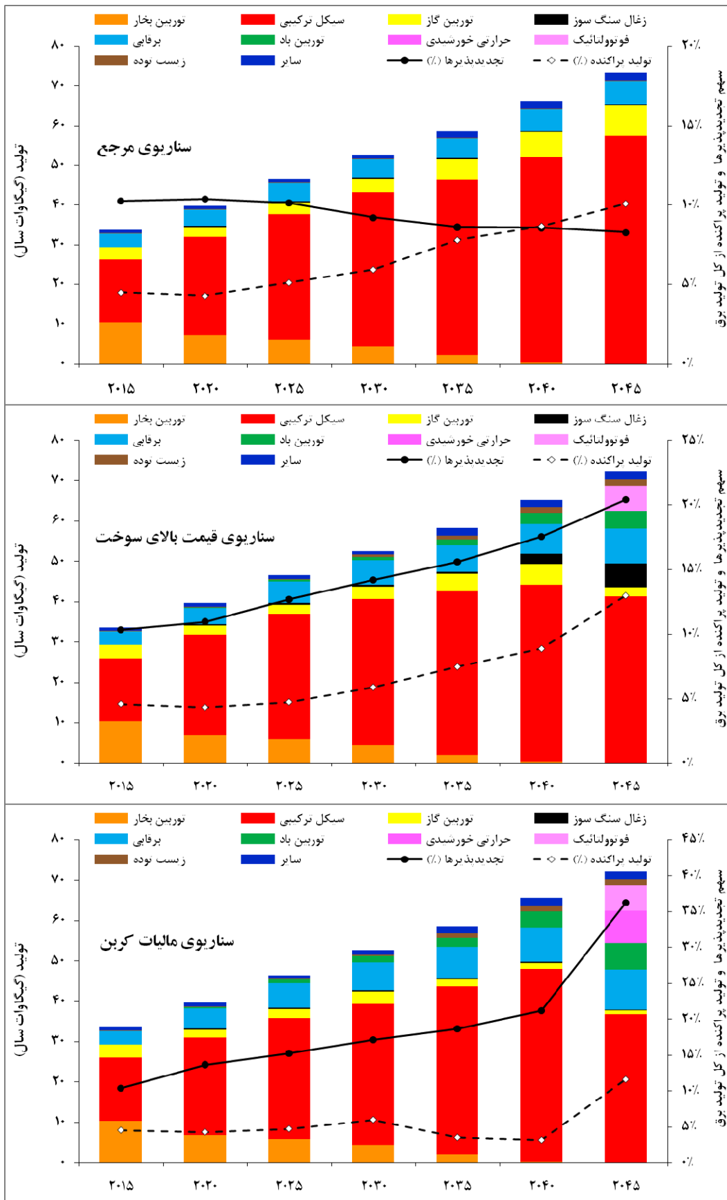
شکل ۴. روند بهینه تولید برق و سهم انرژی‌های تجدیدپذیر از کل تولید در سناریوهای مختلف
