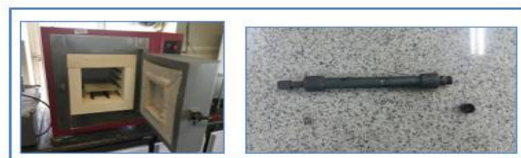
شکل ۱. راست) محفظه رآکتور پیرولیز بیوجار. چپ) کوره حرارتی جهت اعمال تغییرات دمایی و پیرولیز
