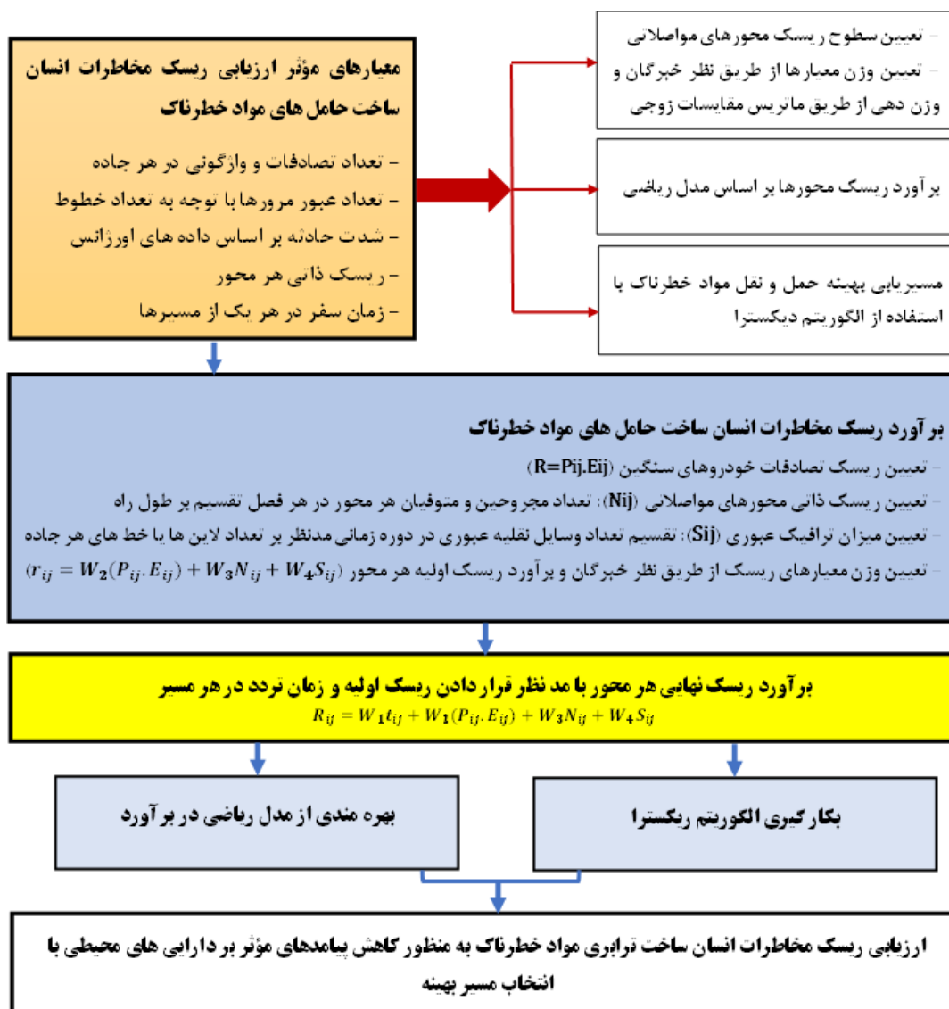
شکل ۶. مدل و الگوی ارزیابی ریسک مخاطرات انسان ساخت ترابری مواد خطرناک (منبع: یافته‌های تحقیق)
