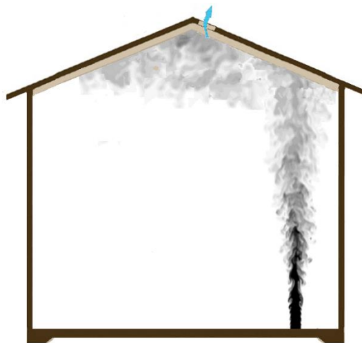
شکل ۱. الگوی شماتیک از رفتار عمومی پلوم آلودگی در هوای ساکن داخل ساختمان
