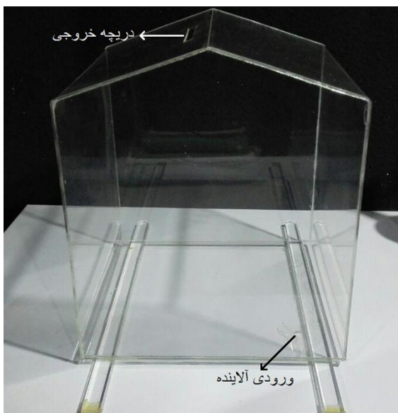
شکل ۲. راست هندسه مورد مطالعه، چپ) مدل آزمایشگاهی ساختمان از جنس پلکسی‌گلاس
