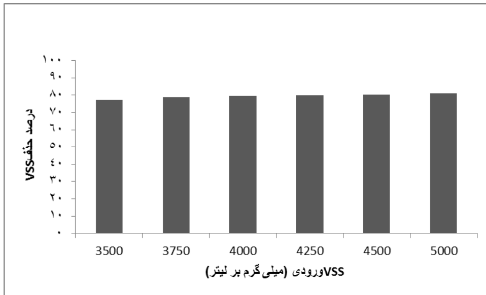
شکل ۳. نمودار نتایج آزمایش رابطه بین کارآمدی حذف VSS و غلظت مواد آلی ورودی به سامانه
